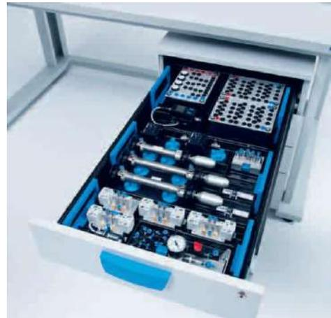
В состав комплекта входят Комплект элементов FESTO TP 101 «Обучение основам пневматики», Комплект элементов FESTO TP 201 «Базовое обучение в области электропневмоавтоматики», а также универсальное средство для моделирования и проектирования FluidSim®-P
