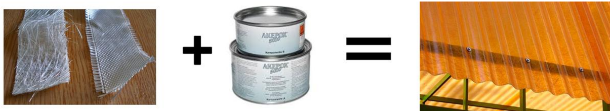
Рис. 3. Кровельный материал из отходов.
