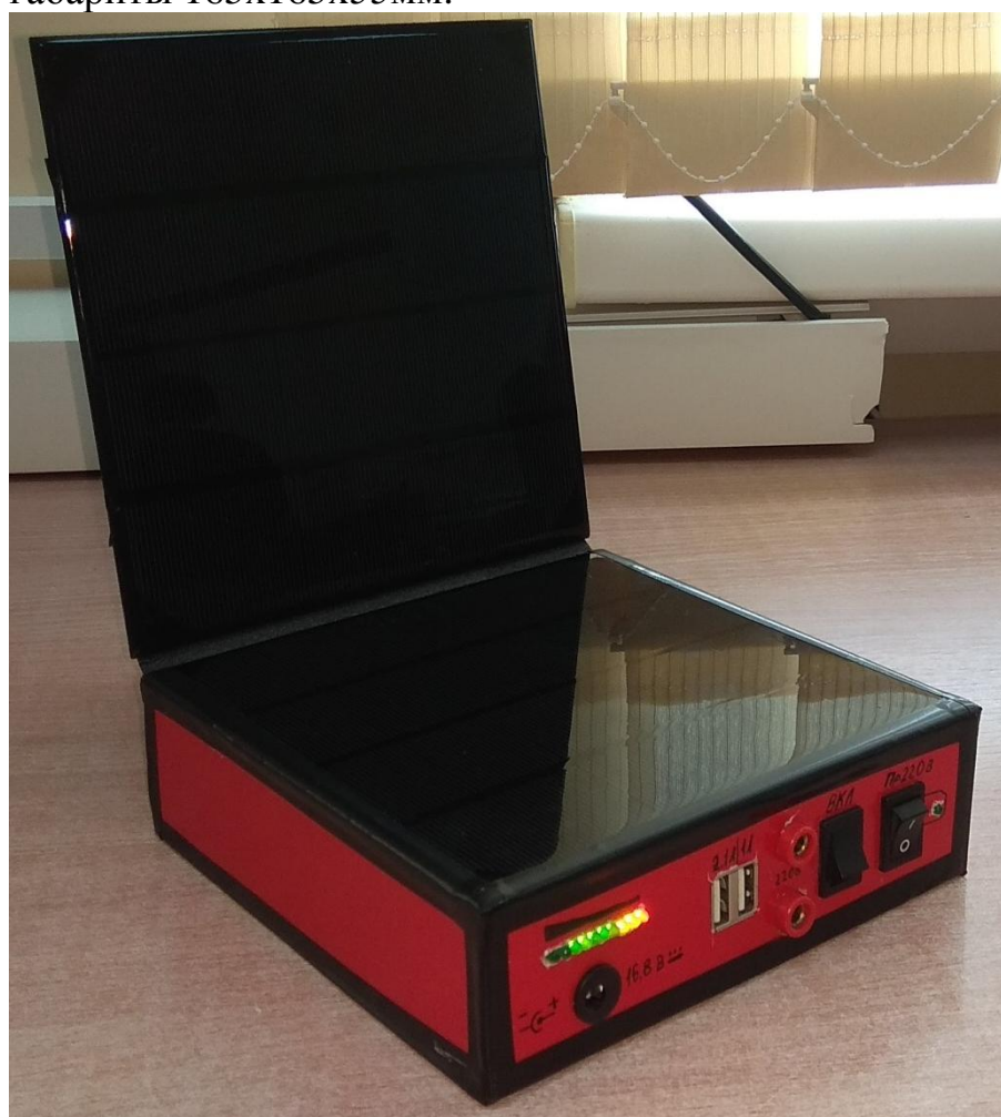
Рис. 1 Внешний вид Multi Power Bank (солнечные панели раскрыты)
